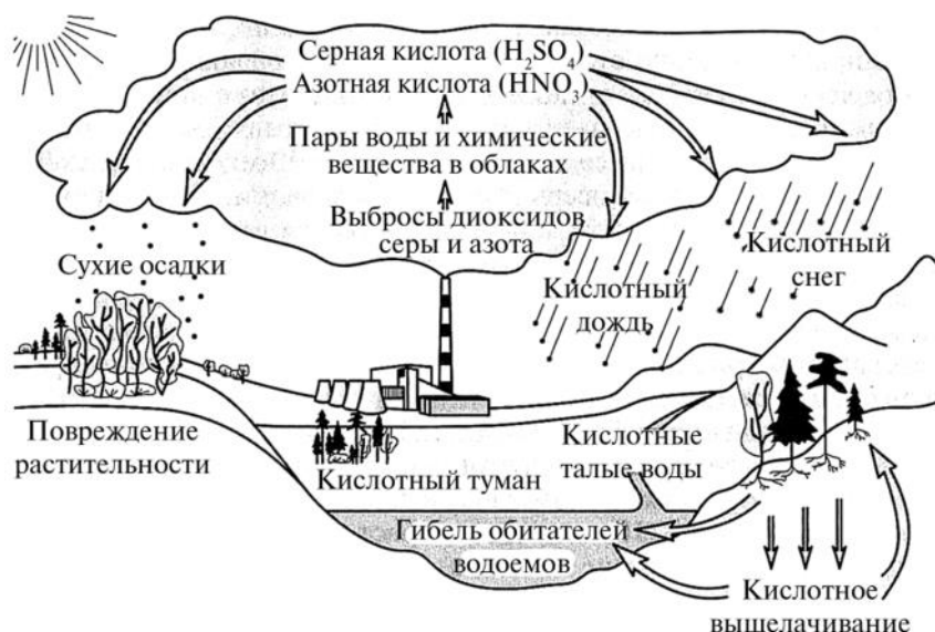
Схема образования кислотных осадков и их многообразного воздействия на экосистемы (по Б. Небелу)
